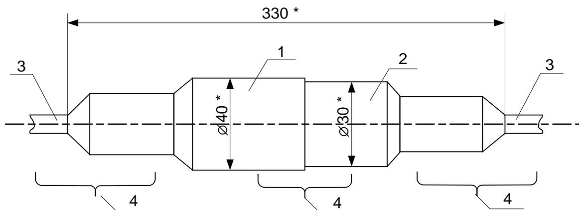
1 – внешняя полумуфта; 2 – внутренняя полумуфта, 3 – подводимый кабель; 4 – места установки термоусадочных трубок.
