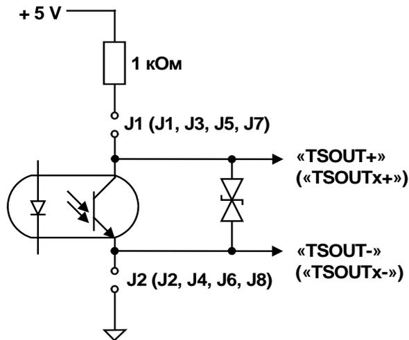
Рис.Б.1. Схема оконечного каскада универсальных выходов.
