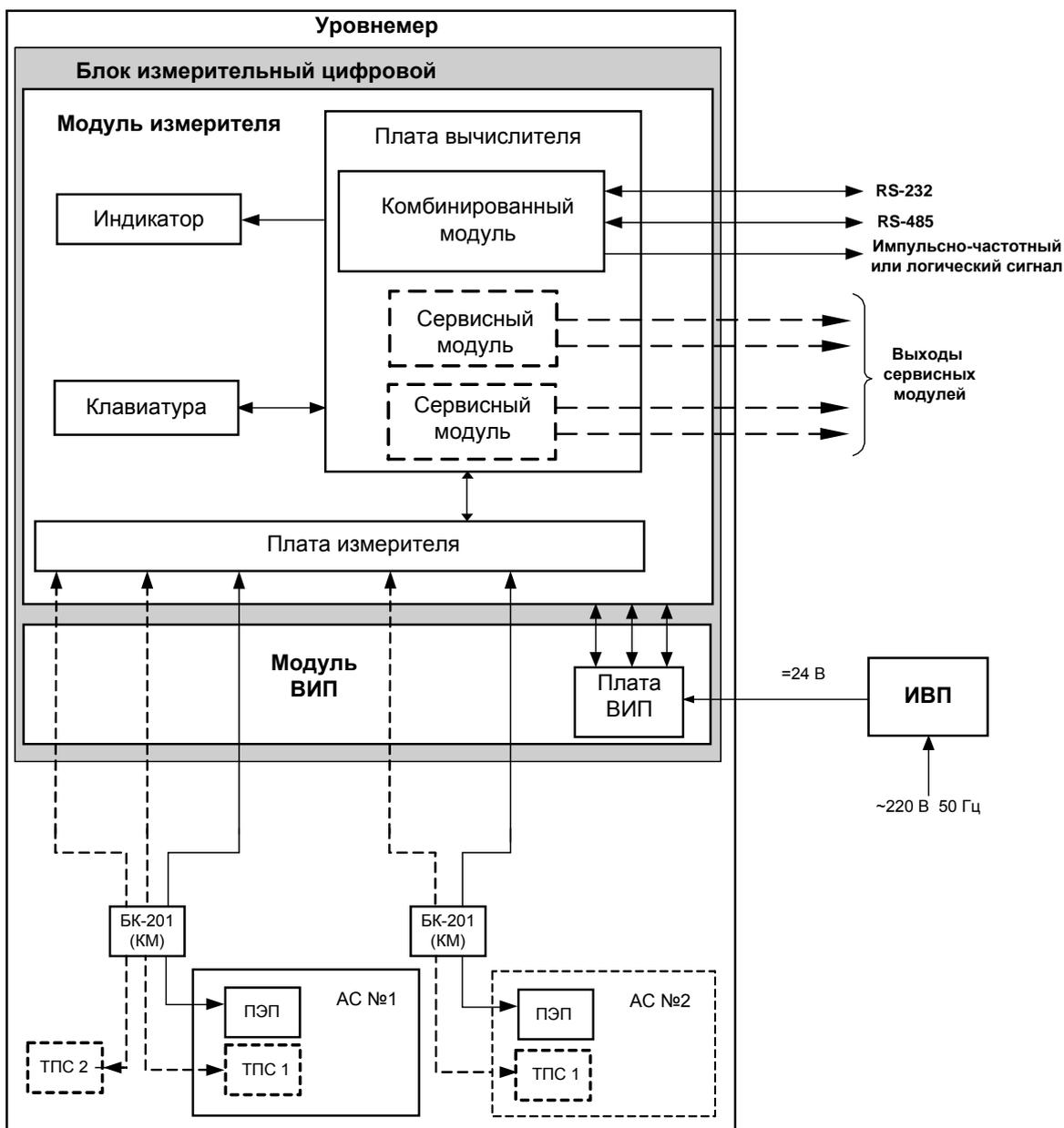
*АС – акустическая система; ВИП – встроенный источник питания; ИВП – источник вторичного питания; ПЭП – пьезоэлектрический преобразователь; БК – блок коммутации; КМ – кабельная муфта (при использовании АС-11х-хх3); ТПС – термопреобразователь сопротивления.*
