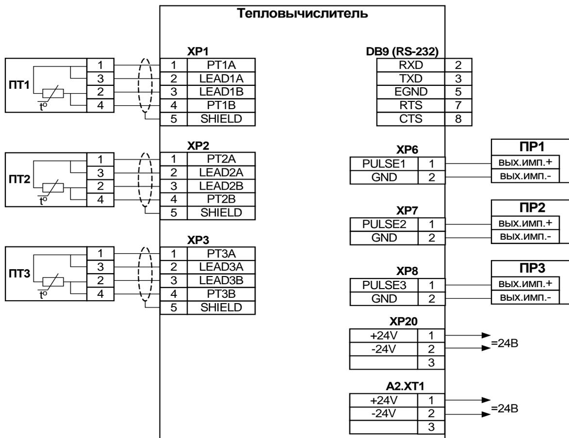
ПРИМЕЧАНИЕ. Источник вторичного питания =24В подключается только к теплосчетчику исполнения ТСП-034.
