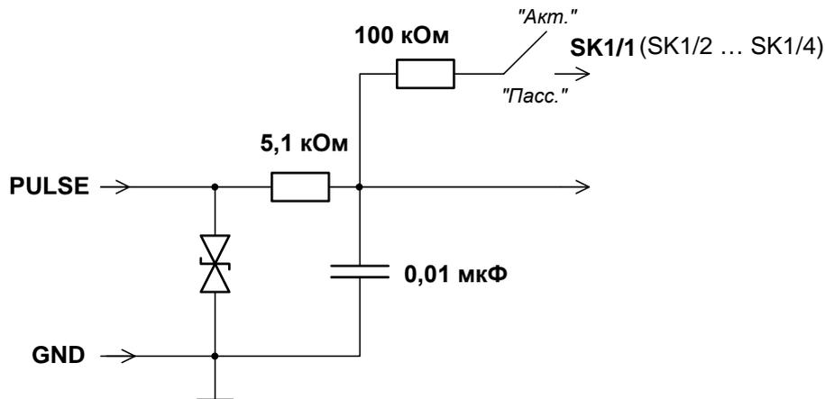
Входной каскад может работать в двух режимах, устанавливаемых при помощи переключателя SK1:
