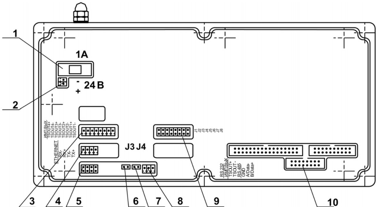
1 – предохранитель; 2 – разъем подключения кабеля питания +24 В; 3 – разъем универсальных выходов 1-4 сервисного модуля; 4 – разъем модуля Ethernet; 5 – разъем подключения кабеля связи RS-232; 6, 7 – контактные пары для установки режима управления ТВ J3 и J4 соответственно; 8 – разъем подключения кабеля связи RS-485; 9 – контактные пары для установки режимов работы универсальных выходов 1-4 сервисного модуля; 10 – разъемы для подключения шлейфов связи с модулем коммутации.
