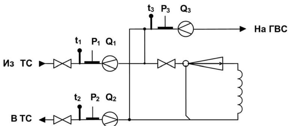
Рис. Г.8. Схема потребления А23-12 (Открытая система теплоснабжения с суммарной тепловой нагрузкой > 0,5 Гкал)
