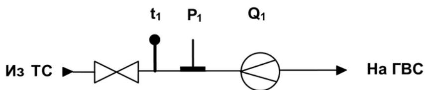
Рис. Г.5. Схема потребления А11-12 (система ГВС тупиковая)
