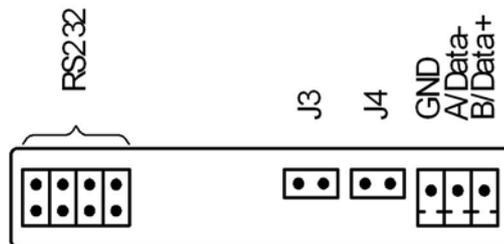
Рис. А.3. Обозначение контактных элементов на субблоке обработки данных
