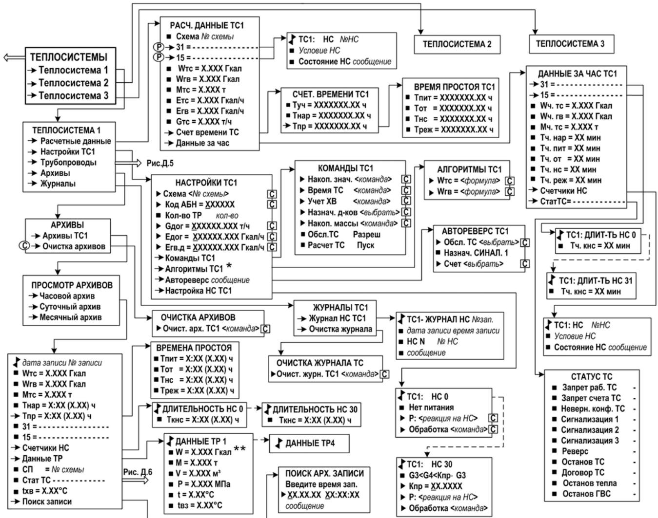
\* - выбор формул расчета  $W_{тс}$  и  $W_{гв}$  из списка возможен только при назначении схемы ТС «Пользовательская»;
