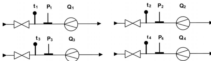
Рис. Г.12. Схема «Пользовательская» с гибкой конфигурацией тепла и массы, и выбором числа трубопроводов от 1 до 4
